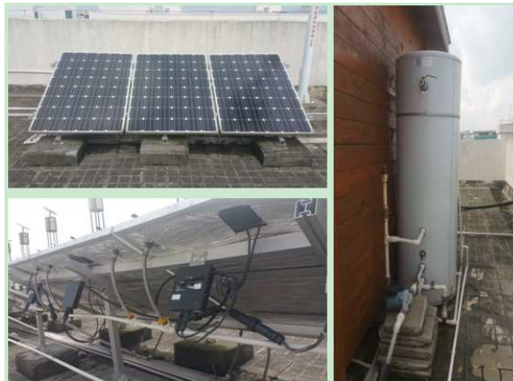
Fig. 7. Actual setup of the PV / T system test rig
